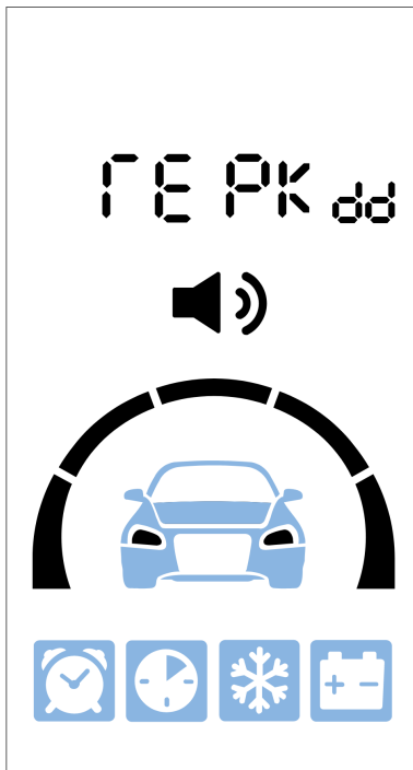
Рис. 3. Индикация при нарушении зоны датчика движения в BLE-герконе на брелоке с вертикальным дисплеем
